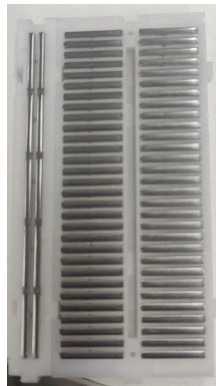
面包板内部结构图，分区横向连通，竖条为正负极
